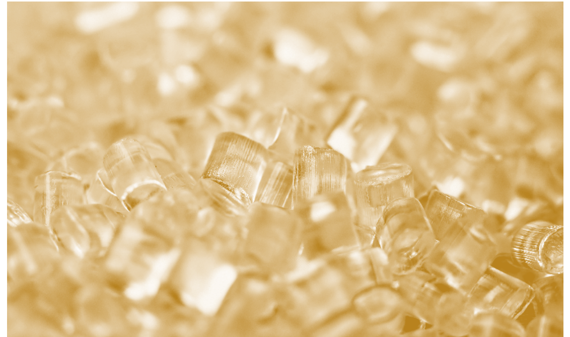
Een thermoplast is kunststof dat bij verhitting zacht wordt.
